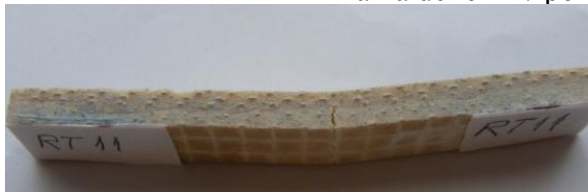
Fig. 2.11. Epruvetă din material compozit țesătură de sticlă EWR145 / făină de lemn de stejar / poliester Copoly, testată la încovoiere după imersiune timp de 5612 ore în apă
