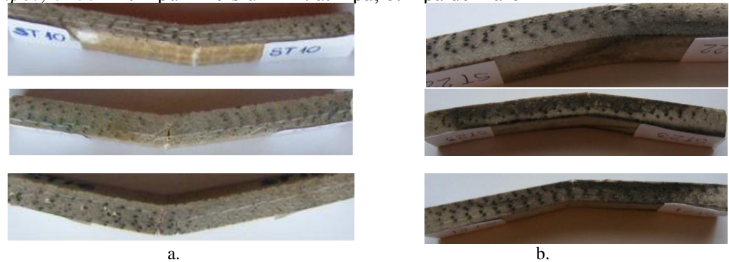
Fig. 2.12. Fotografii ale epruvetelor (după încovoiere) din material compozit țesătură de sticlă EWR145 / făină de lemn de stejar / poliester Copoly 7233, degradate după imersiune timp de 5853 ore în: a. Apă; b. Apă de mare
