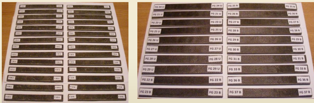
Fig. 1.6. Epruvete pentru încercarea de încovoiere fabricate din material compozit: In / rășină epoxi; b. Sticlă-E / in / rășină epoxi (SR EN ISO 14125, 2000)
