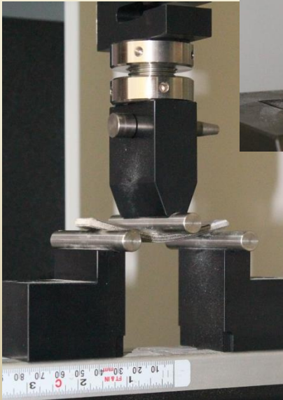
Fig. 1.6. Epruvete pentru încercarea de încovoiere fabricate din material compozit: In / rășină epoxi; b. Sticlă-E / in / rășină epoxi (SR EN ISO 14125, 2000)
