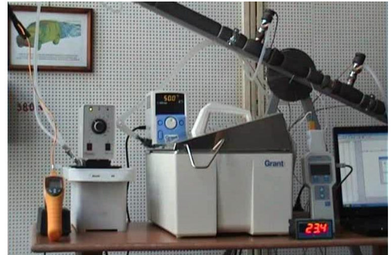
Instalația experimentală pentru testarea tuburilor termice
