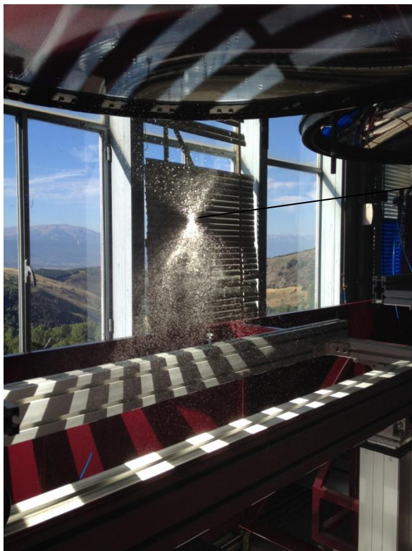
Fig. 2.7 Stabilirea poziției spotului de energie solară (CNRS-PROMES)
