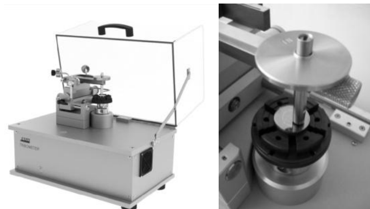
Fig. 2.41 Tribometru rotativ utilizat pentru determinarea comportamentului tribologic al probelor [14, 26]
