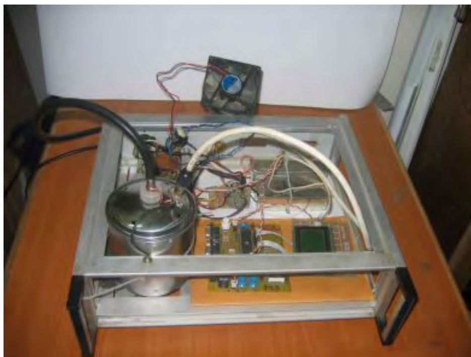
Figura 1.28. aparatul de măsurare a concentrației de Radon cu cameră de ionizare, vedere în interior
