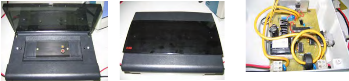
Figura 2.15. Model experimental de dispozitiv de protecție: în carcasă cu capac deschis (stânga), cu capac închis (mijloc) și vedere din interior (dreapta)
