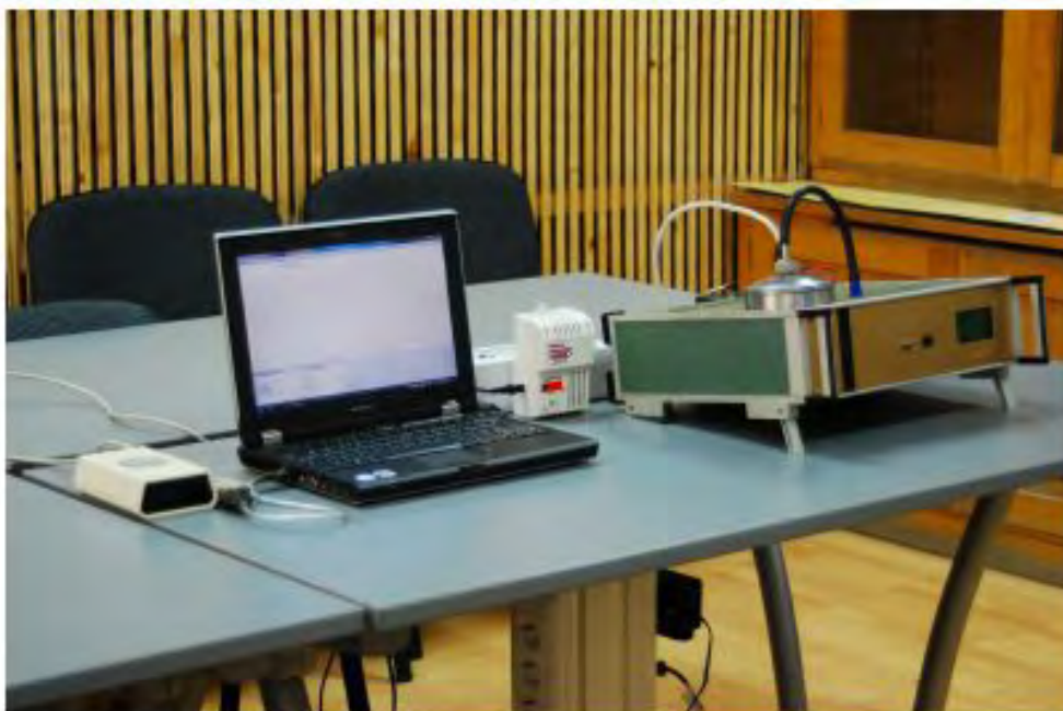
Figura 1.29. Aparatul de măsurare a concentrației de Radon cu cameră de ionizare, în teste alături de un aparat Safety Siren 2 și un contor electronic Geiger Muller
