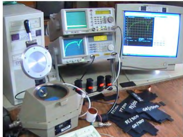
Figura 3.8. Schema de măsurare în incinta TEM și standul de măsurare
