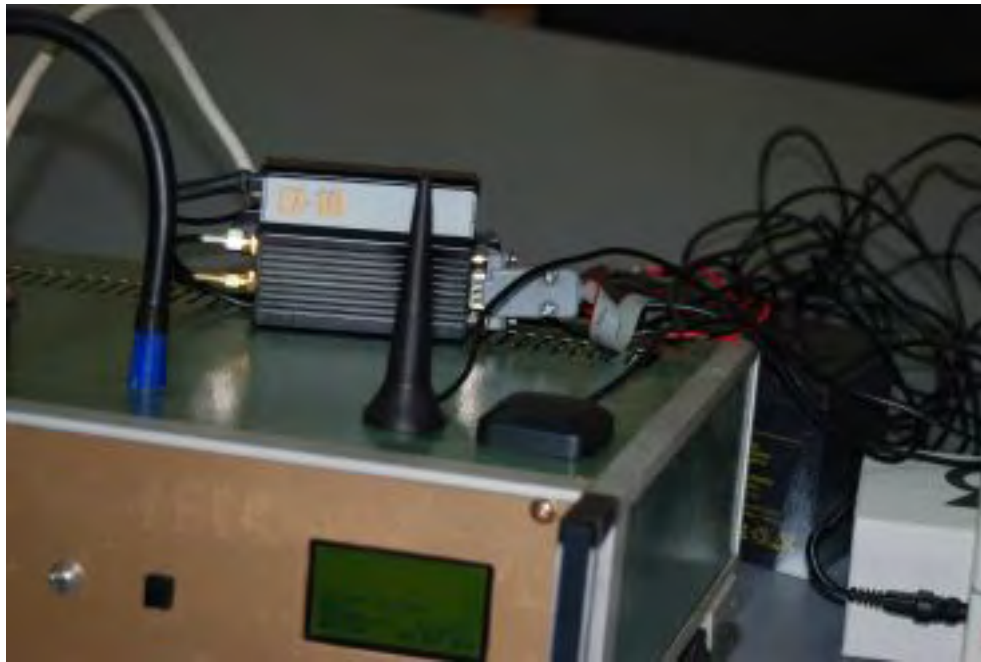
Figura 1.31. Aparatul de măsurare a concentrației de Radon cu cameră de ionizare, modulul GPS/GPRS EZ10 și afișajul LCD
