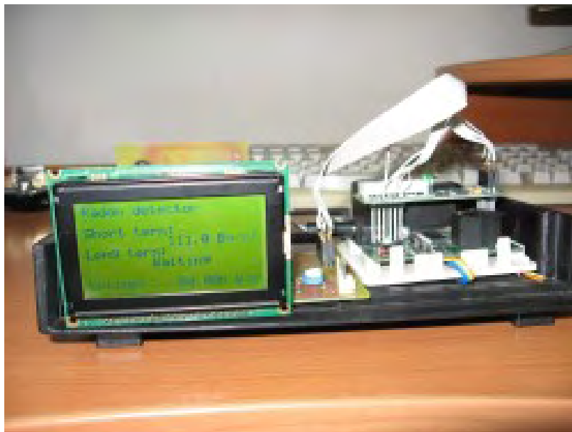
Figura 1.20. Aparatul de măsurare a conținutului de Radon în aer cu cameră de detecție (vedere din față)
