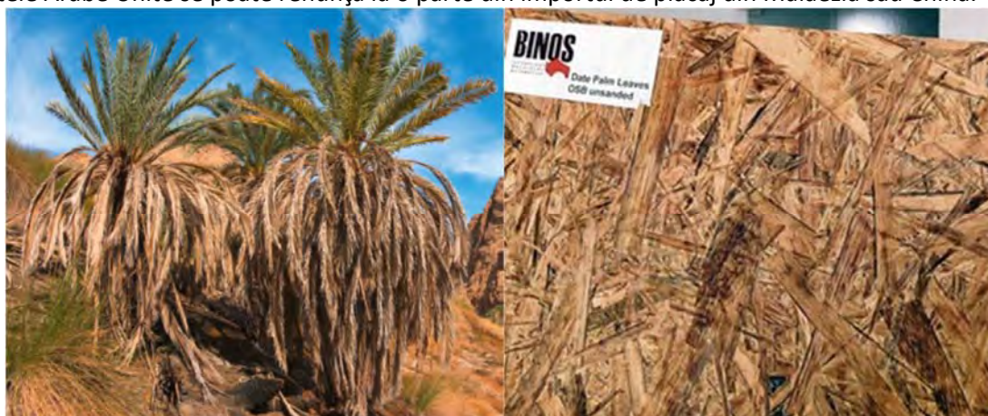
Figura 1.3.2.1.3: Palmieri cu frunze uscate (stânga) și OSB fabricate din acestea (dreapta) [Paulitsch&Barbu, 2015 după Binos]
