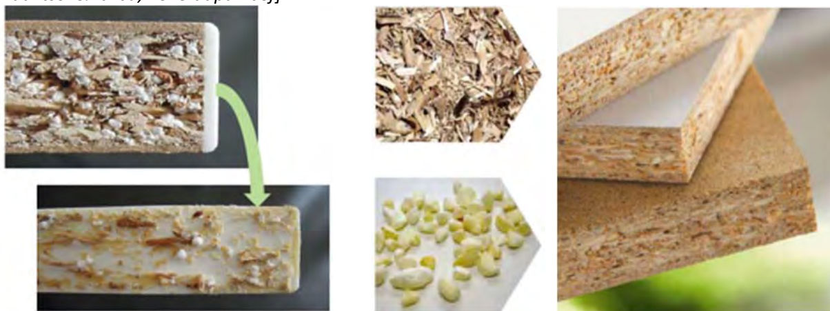
Figura 2.1.2: Superpan Star cu fețe din fibre și miez din aşchii și EPS cu canturi din ABS (stânga sus) și după testul de dezlipire (stânga jos)[Paulitsch&Barbu, 2015 după Basf și Finsa]; Aşchii de miez și floricele din porumb industrial mărunțite (centru), respectiv placă ușoară tip PAL BalanceBoard (dreapta) [Paulitsch&Barbu, 2015 după Pfliederer]
