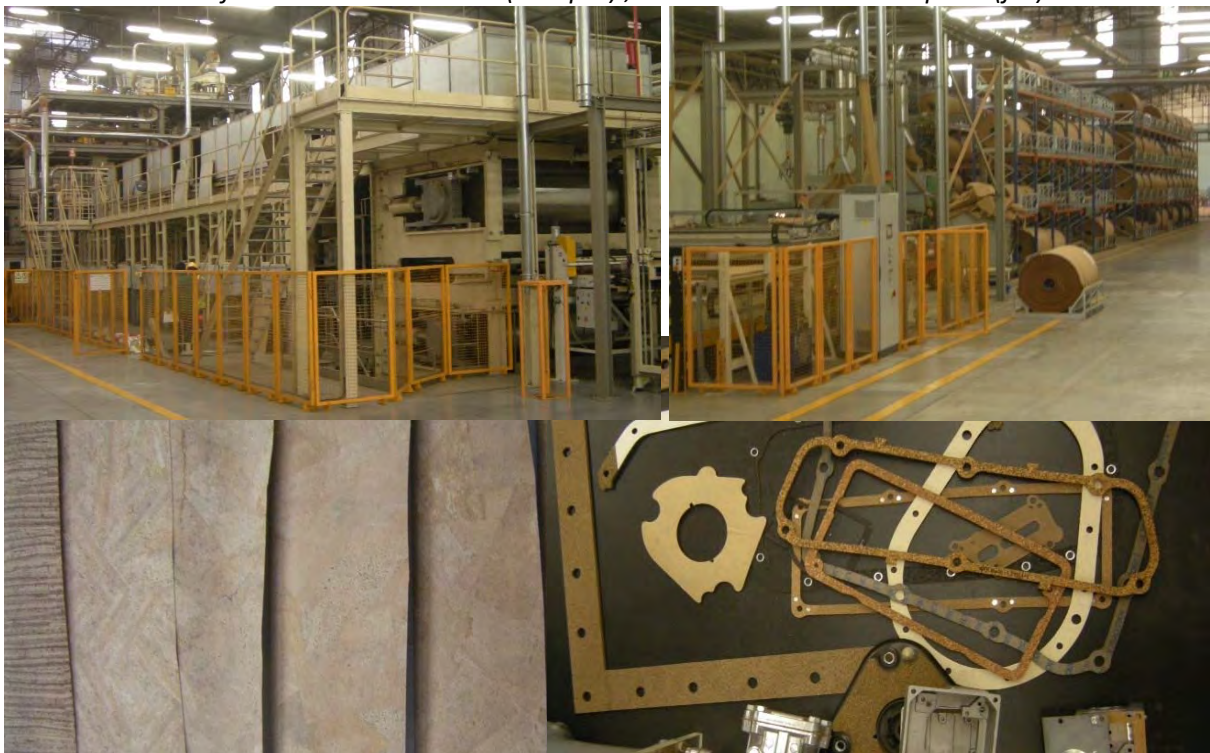
Figura 1.3.2.4.26: Presă continuă cu bandă dublă pentru producția de folii din plută (stânga, sus); Depozitarea intermediară a rolerilor în rafturi (dreapta sus); Exemple de produse finale din folii de plută: suprafețe decorative (stânga jos) și garnituri de mașini ștanțate (dreapta jos) [Paulitsch&Barbu, 2015]
