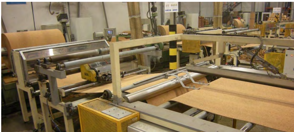
Figura 1.3.2.4.25: Depozitarea cilindrilor din granulat de plută înleiat (stânga); Centrarea și fixarea cilindrilor între vârfuri în vederea derulării (dreapta) ; Derularea cilindrilor din plută (jos)
