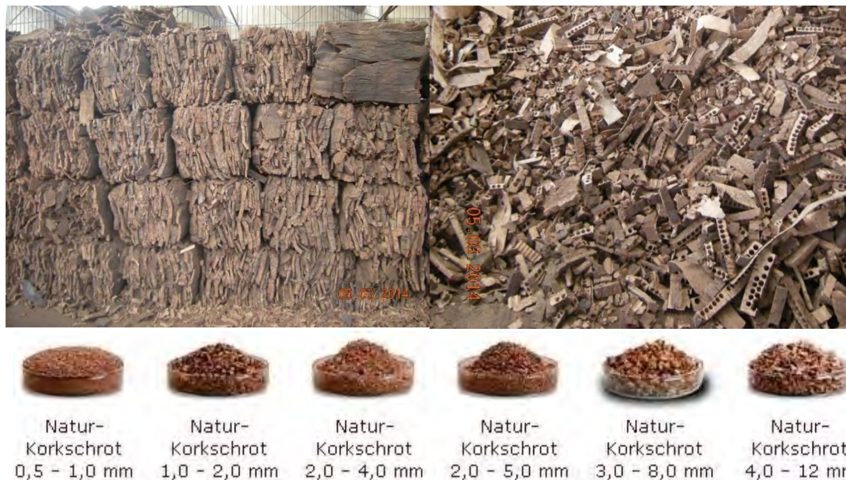
Figura 1.3.2.4.24: Calitate inferioară de plută este balotată (stânga sus); deșeurile rezultate din producția de plută (dreapta sus); Frațiuni din granulat din plută (jos)[Paulitsch&Barbu, 2015 după Amorim]
