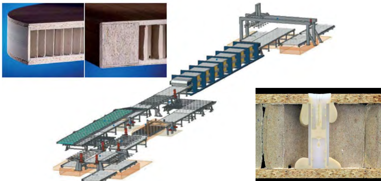
Figura 2.1.5: Flux tehnologic pentru producția de plăci cu miez fagure fără rame tip Eurolight cu presa continuă (centru)[Paulitsch&Barbu, 2015 după Siempelkamp]; Placă cu miez fagure fără și cu ramă tip Eurolight (stânga); Detaliu al secțiunii transversale cu diblu special cu autofixare (dreapta) [Paulitsch&Barbu, 2015 după Egger]
