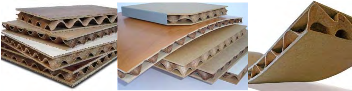
Figura 2.1.9: Lisocore: panouri cu miezuri speciale 3D din fibre textile și sintetice realizate prin tehnologia nonwoven [Paulitsch&Barbu, 2015 după Lightweight Solutions]
