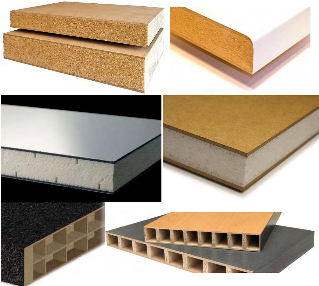
Figura 2.1.6: Miez din LDF (Homalight) (stânga sus), sandwich cu fețe din UT-HDF finisat postforming (dreapta sus) [Paulitsch&Barbu, 2015 după Homanit]; Sandwich cu miez din spumă și fețe din HDS (HPL) (centru stânga), respectiv HDF (centru dreapta)[Paulitsch&Barbu, 2015 după Weiß-Chemie]; Panouri cu miez din fâșii de UT-HDF îmbinate (stânga jos) și fâșii aliniate paralel (dreapta jos) [Paulitsch&Barbu, 2015 după Finsa, respectiv Greenpanel]
