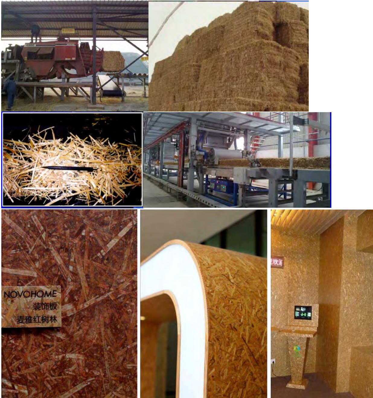
Figura 1.3.2.3.1: Producția OSB din paie de orez în Yangling: instalație de balotat și depozitare provizorie (sus); segmente din paie și covorul din paie pe banda transportoare înainte de presare (centru); exemple de OSSB pentru design interior (jos) la pavilionul Expo2010 din Shanghai [Han, 2012 după Novofibre]
