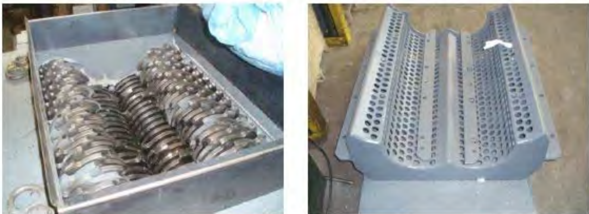
Figura 1.3.2.4.2: Tocător tip shredder cu patru axe, model Untha RS40 [Kain, Barbu et al., 2012]
