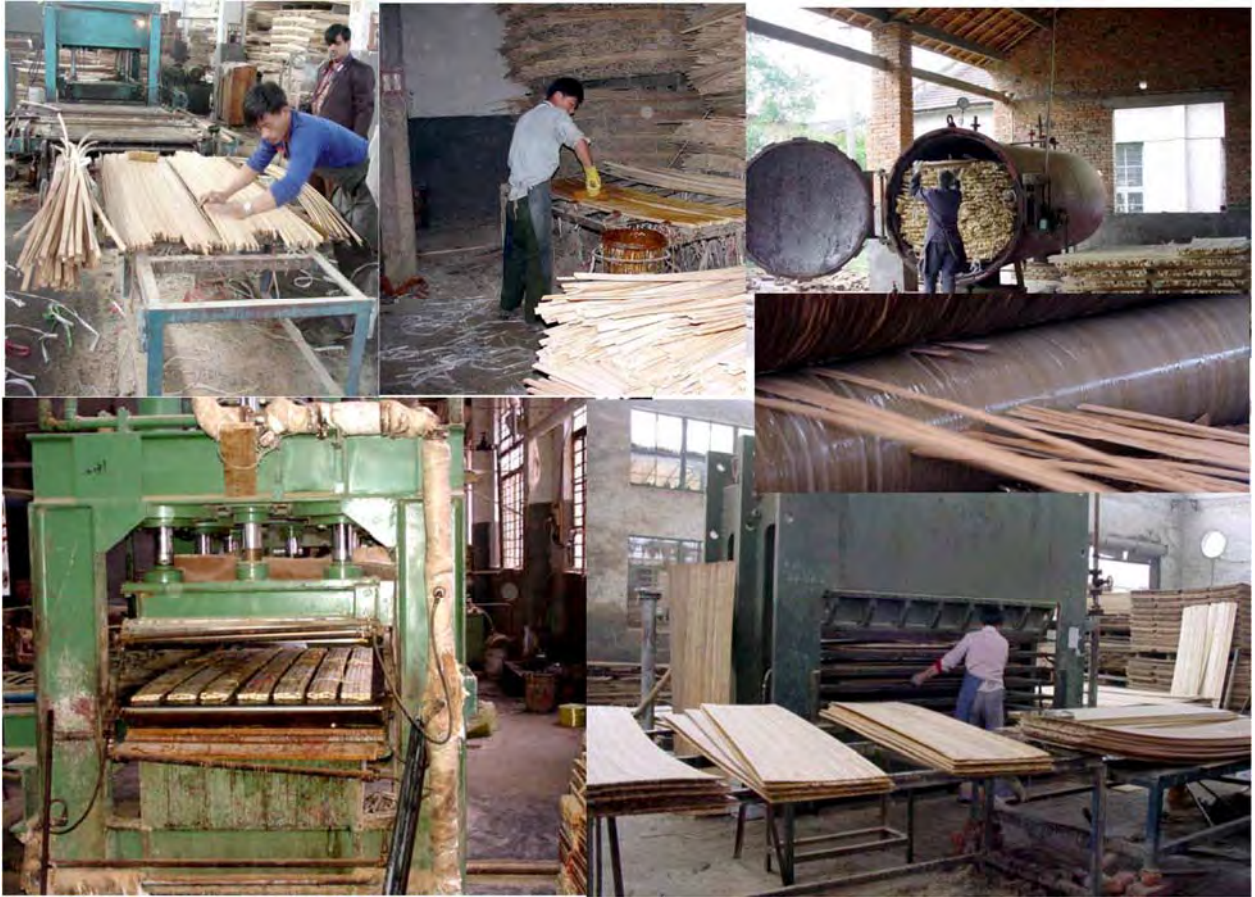
Figura 1.3.2.2.4: Producția plăcilor din fâșii de bambus: calibrare (stânga sus), impregnare (dreapta sus), încliere (dreapta centru), presare (jos)[Paulitsch&Barbu, 2015 după UNDP și Panda Bamboo]
