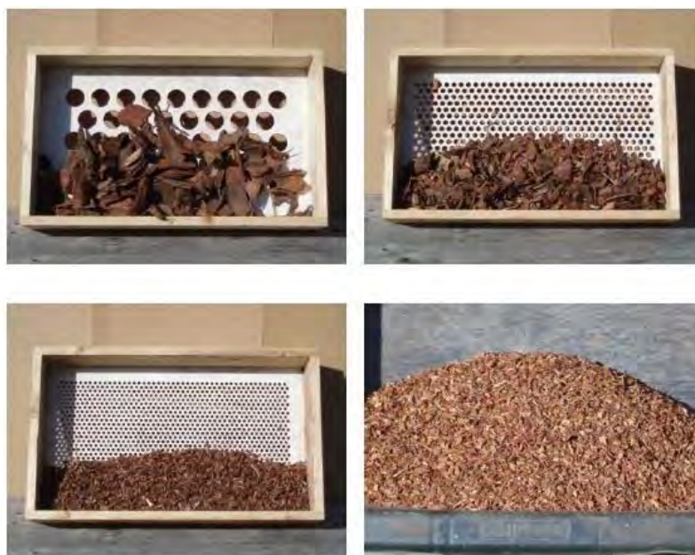
Figura 1.3.2.4.3: Fraționarea cojii de larice prin intermediul sitelor [Kain, Barbu et al., 2012]
