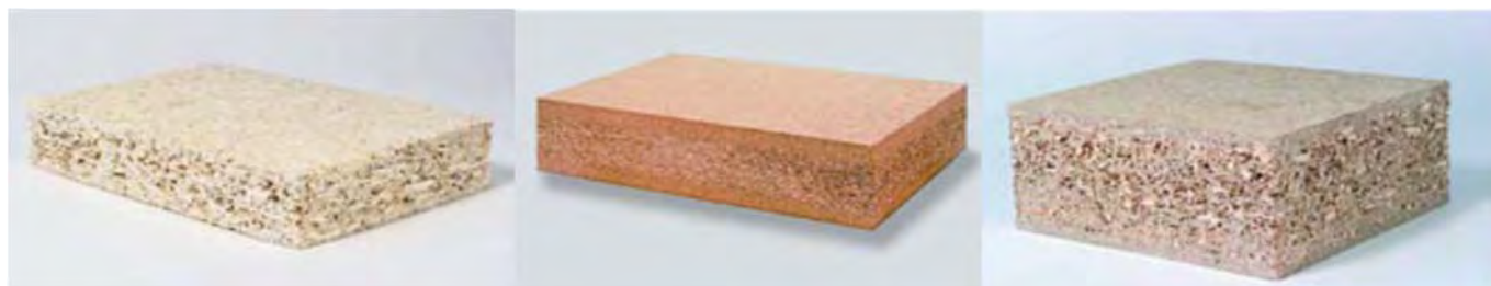
Figura 1.3.2.1.1: Exemple de plăci compozite ușoare (PAL) produse industrial din reziduri de plante textile: cânepă (stânga), paie cereale (centru), in (dreapta) [Paulitsch&Barbu, 2015]
