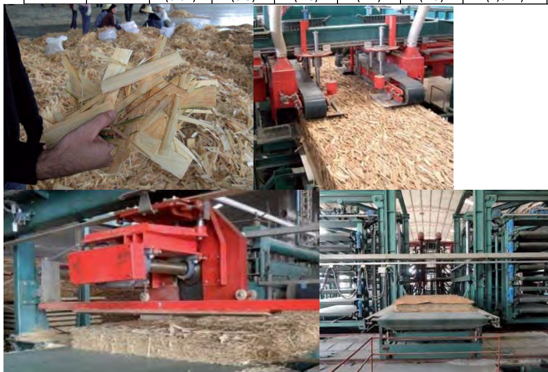
Figura 1.3.2.2.8: Fabricarea industrială a OSB din bambus (BOSB)[Paulitsch&Barbu, 2015 după Botting]
