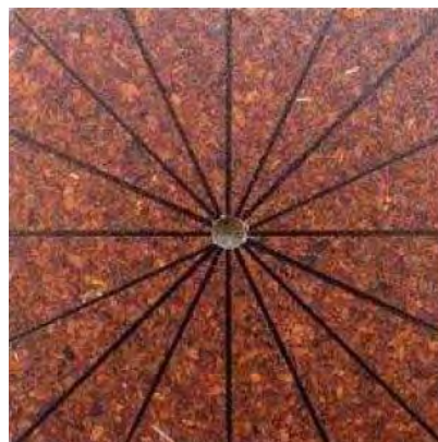
Figura 1.3.2.4.22: Epruvetă împărțită în 16 sectoare pentru analiza rezistenței la abraziune conform EN 14354: 2007 [Tudor, Barbu et al., 2016]
