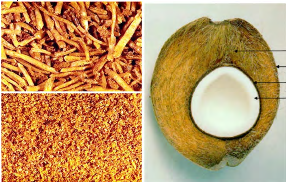
Figura 1.3.2.2.10: Frațiuni de mezocarp uscat și mărunțit (stânga) [Glowacki, Barbu et al., 2012]; secțiune printr-o nucă de cocos cu endo, mezo și exocarp (dreapta) [Van Dam et al., 2004]
