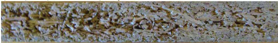
Figura 2.1.3: Detaliu al secțiunii transversale a PAL ușor tip BoBoard cu trecerea dintre zona de densitate redusă (< 500 kg/m 3 ) la cea ridicată (> 600 kg/m 3 ) [Paulitsch&Barbu, 2015 după Swedspan]
