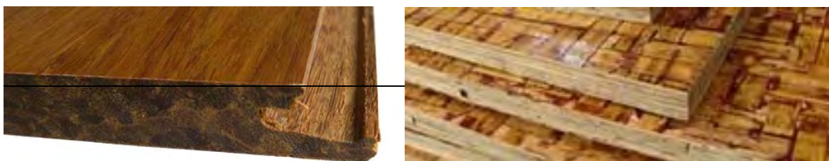
Figura 1.3.2.2.6: Plăci din fâșii de bambus zdrobite, încleiate și densificate prin tehnologia „scrimber” (stânga) [ECW]; placaj din fâșii de bambus împletite și încleiate (dreapta) [Paulitsch&Barbu, 2015 după Alibaba]
