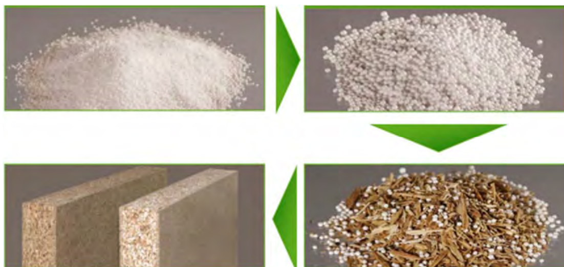
Figura 2.1.1: Granule de polistiren (PS) neexpandat (stânga sus); polistiren expandat (EPS) (dreapta sus), amestec de aşchii de miez și EPS (dreapta jos); placă ușoară tip PAL Kaurit AirMaXX Light (stânga jos) [Paulitsch&Barbu, 2015 după Basf]
