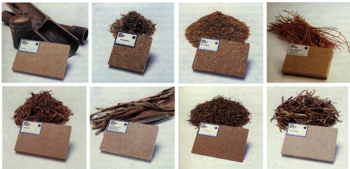
Figura 1.3.2.0: Exemple de plăci realizate din bambus, cânepă, orez, miscanthus (sus), trestie de zahăr, ierburi (elefantului, alfa), paie de grâu (jos) [Barbu, 2002 după Bison]
