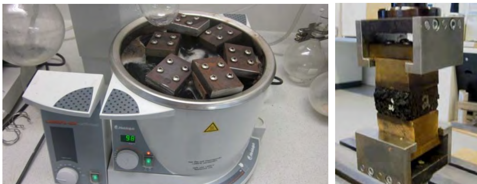
Figura 1.3.2.4.6: Testarea coeziunii interne a unui bloc pentru paleți după fierbere [Heinzmann, 2012]
