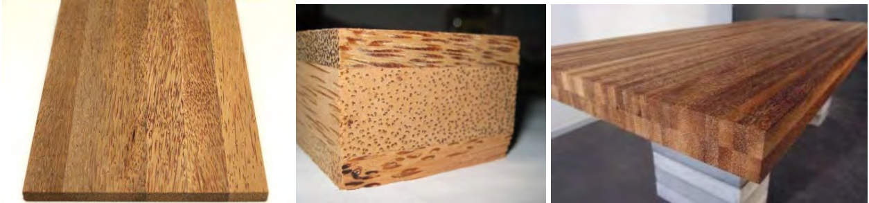
Figura 1.3.2.2.9: Panou unistratificat din lamele de diverse densități (stânga); placă tristratificată din lamele sortate pentru fețe și miez (centru) [Hasemann, 2011]; placă dublu-stratificată pentru interior (dreapta) [Paulitsch&Barbu, 2015 după Cocosline]
