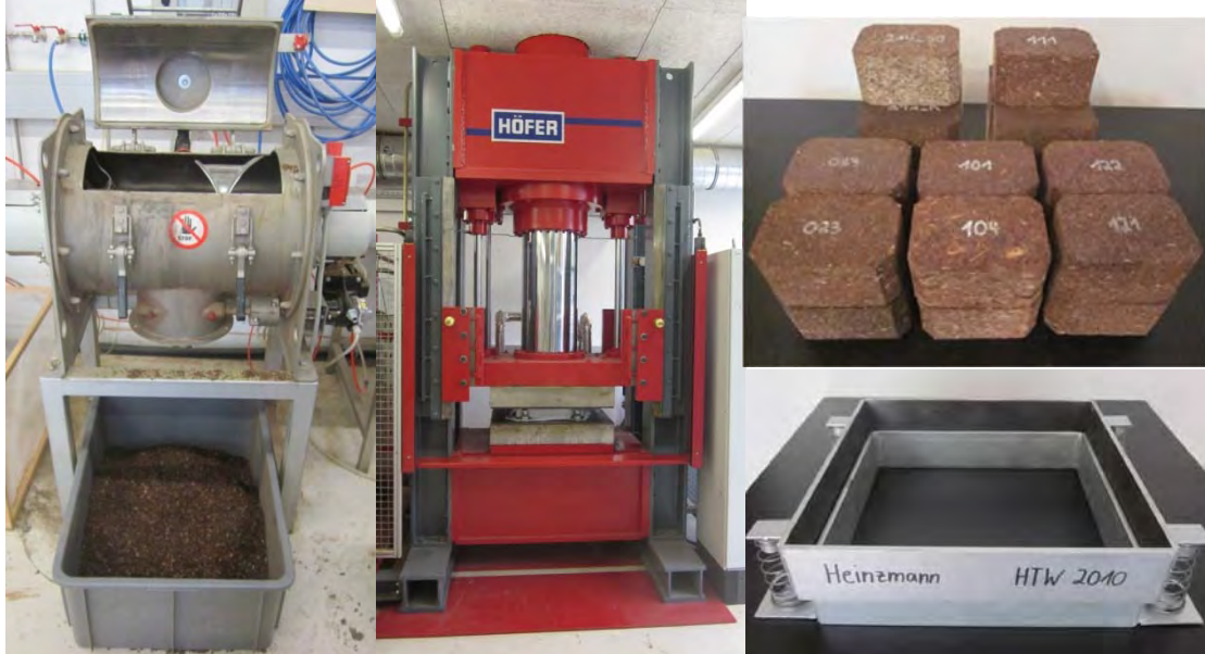
Figura 1.3.2.4.5: Echipamente de laborator pentru înclierea (stânga) și presarea (centru) în forme speciale (dreapta jos) a cojii de molid în blocuri pentru paleți (dreapta sus) [Heinzmann, 2012]
