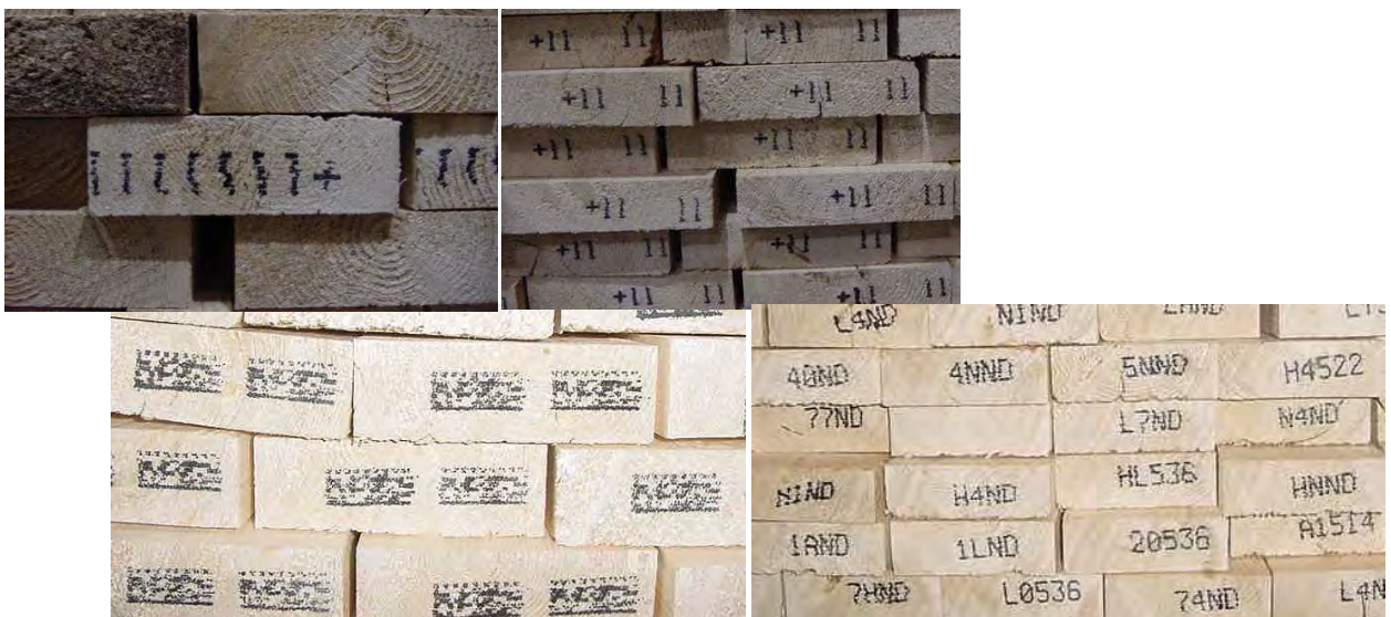
Figura 3.2.1: Diverse forme de imprimare a propriei vibrații: bară, binar, matrice, cod [GreCon, MicroTec]
