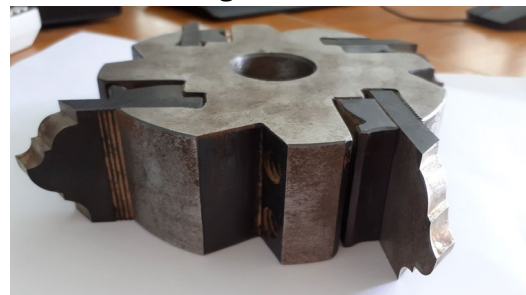
Fig. 44. The cutter head used in the milling process (Brenci și Gurău 2024)
