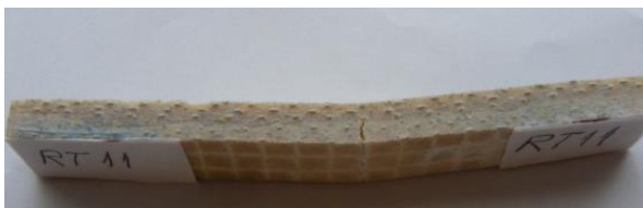
Fig. 2.11. Epruvetă din material compozit țesătură de sticlă EWR145 / făină de lemn de stejar / poliester Colpoly, testată la încovoiere după imersiune timp de 5612 ore în apă
