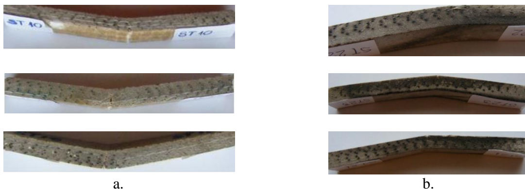
Fig. 2.12. Fotografii ale epruvetelor (după încovoiere) din material compozit țesătură de sticlă EWR145 / făină de lemn de stejar / poliester Colpoly 7233, degradate după imersiune timp de 5853 ore în: a. Apă; b. Apă de mare
