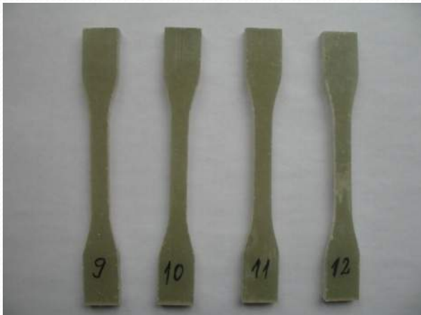
Epruvete polimerizate timp de 24 ore la 20°C
