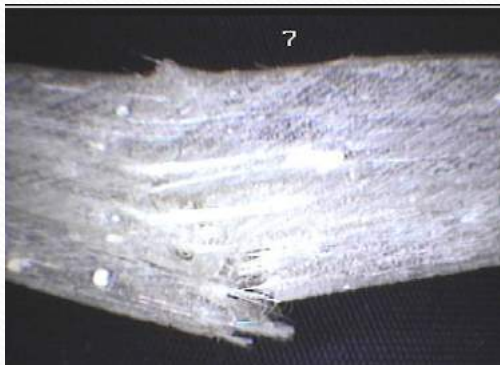
Epruveta 7, tesatura pe urzeala, marire 5x, respectiv 500x
