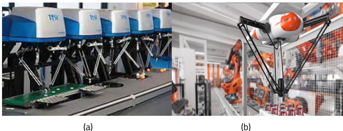
Fig. 1.6. Utilizarea roboților Delta în: (a) industria de asamblare [18]; (b) industria de ambalare [19].
