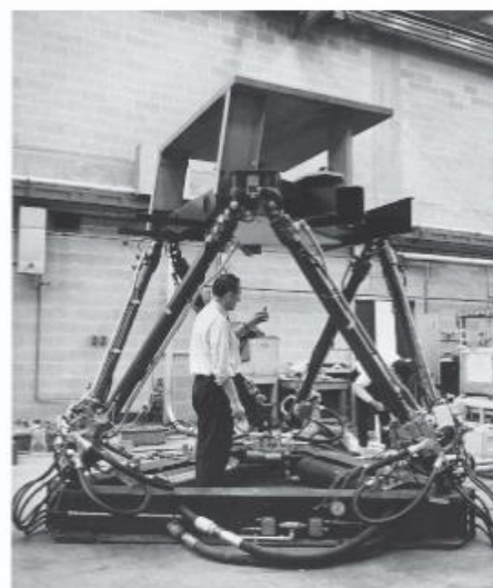
Fig. 1.2. Primul simulator de zbor bazat pe un hexapod octaedral al lui K.L. Cappel [7].
