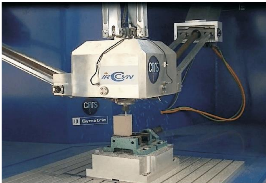
Fig. 1.14. Robotul paralel Orthoglide in 5 axe semindustrial pentru operații de prelucrare [33].
