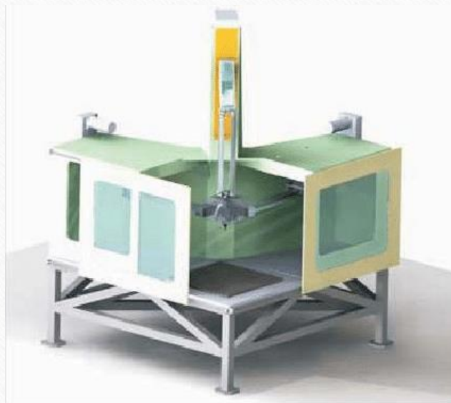
Fig. 1.13. Robotul paralel Orthoglide în 5 axe – machetă digitală [33].
