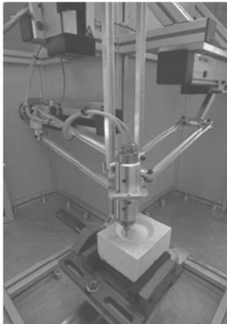
Fig. 1.12. Robotul paralel Orthoglide [30].
