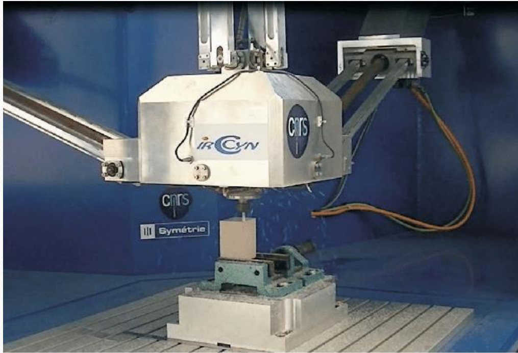
Fig. 1.14. Robotul paralel Orthoglide in 5 axe semindustrial pentru operații de prelucrare [33].
