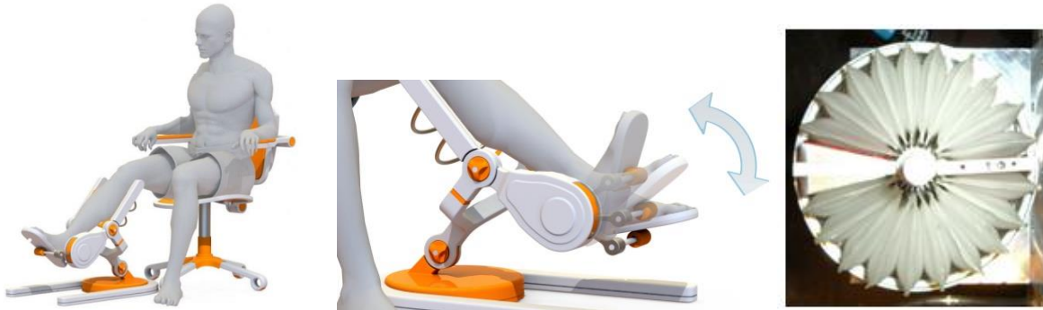
Fig. 4.36 Echipament de reabilitare cu camere elastice rotative acționate fluidic
