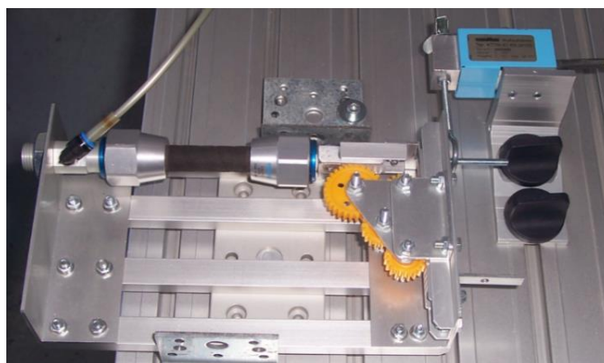
Fig. 4.83 Măsurarea forței dezvoltate de un bac
