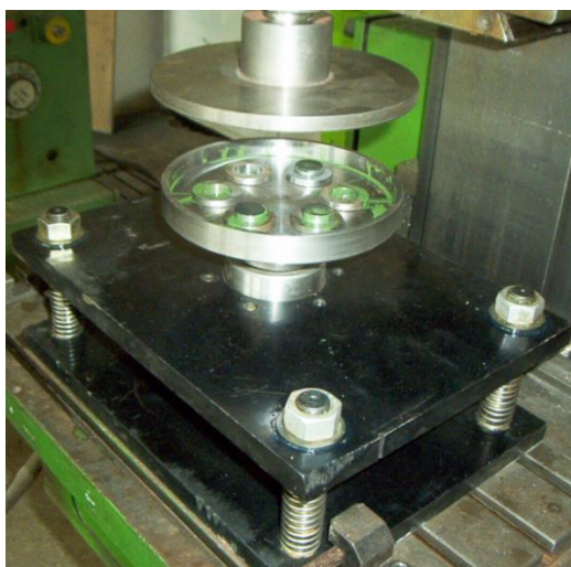
Fig. 3.7 Vedere a echipamentului de lepuire simultan șase semifabricate plane
