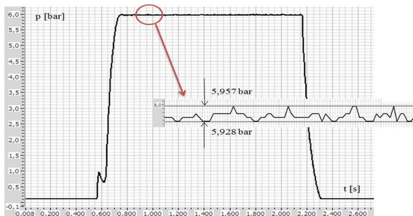
Fig. 4.73 Fluctuațiile de presiune din mușchiul pneumatic
