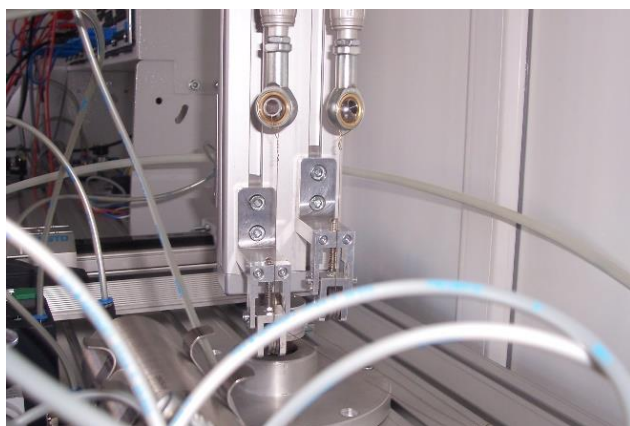
Fig. 4.20 Sistemul de preluare a deplasării capetelor libere ale celor doi mușchi atunci când are loc precomprimarea lor la o presiune p_0 egală cu \frac{1}{2} din presiunea maximă de lucru
