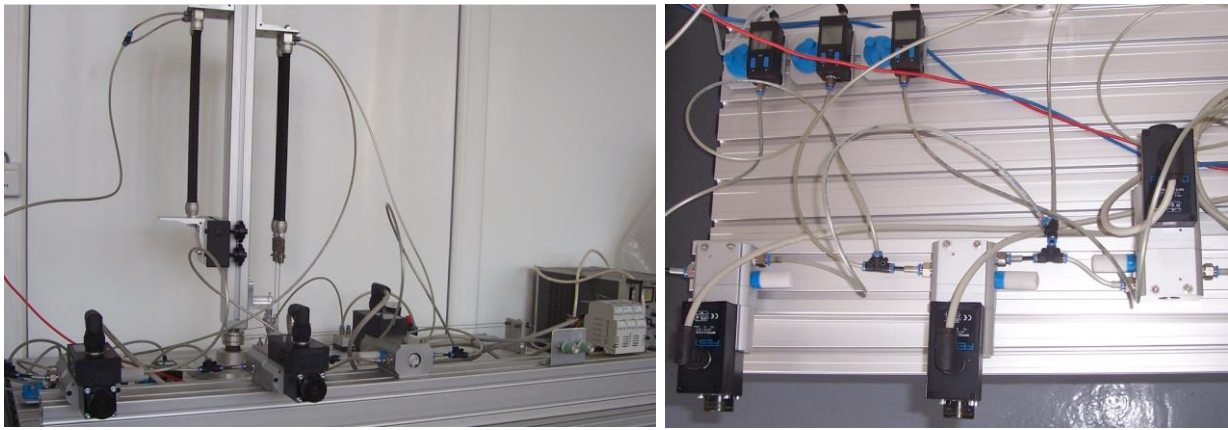
Fig. 4.26 Amplasarea reguletoarelor proporționale și a traductoarelor de presiune pe stand
