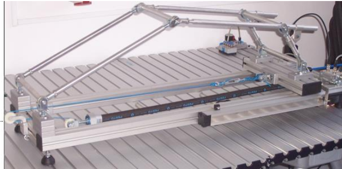
Fig. 3.24 Echipamentul de reabilitare a articulațiilor portante ale membrului inferior
