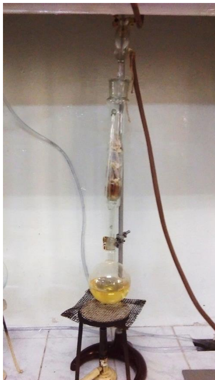
Extracția oleorezinelor din probele de la molid cu aparatul Soxhlet
