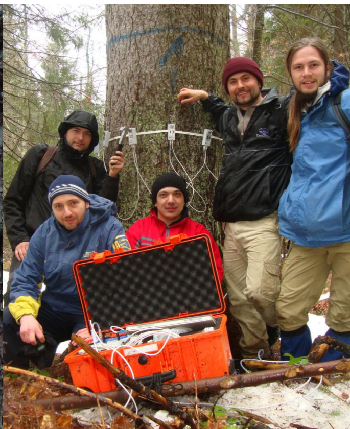
Figura 20. Tomograful Arbotom la o campanie de lucrări de teren în Rezervația Molidul de Rezonanță din Lăpușna
