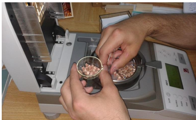
Figura 25. Uscarea unor probe de creștere fracționate de la paltin
