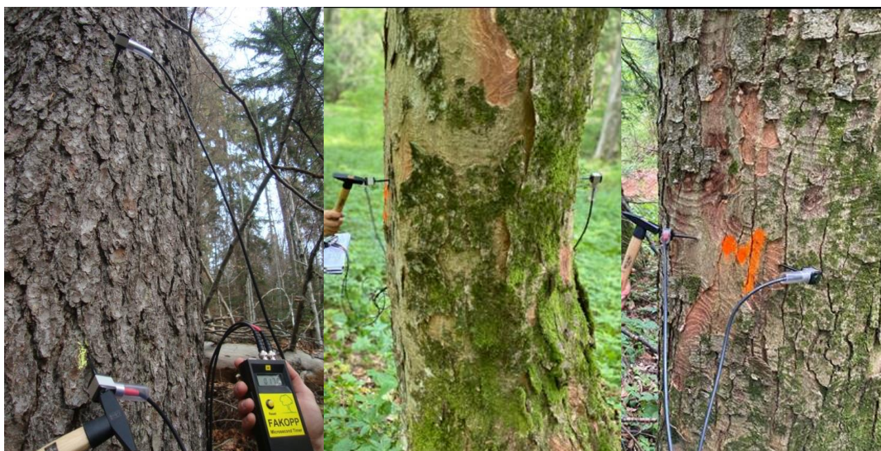
Figura 18. Măsurarea vitezei sunetului pe direcțiile de anizotropie: longitudinală (stânga), radială (mijloc) și tangențială (dreapta) – Dinulică 2020
