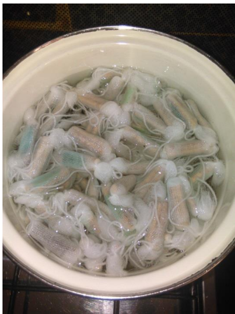
Probe de creștere epuizate de extractibili, ambalate în păpuși din tifon și pregătite pentru fierbere
