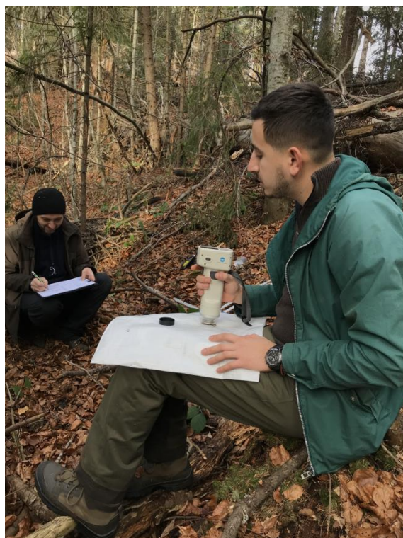
Figura 17. Instantaneu de la colorimetria in situ a probelor de scoarță
