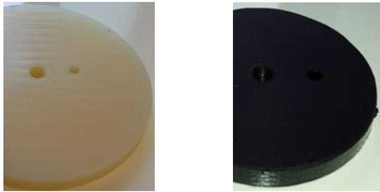
Fig. II.4.28. Discurile executate din poliamida PA66 și, respectiv, PA46
