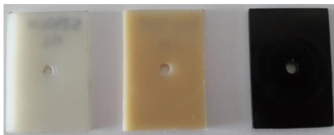
Fig. II.4.33. Plăcuțele PA66, PA46 și, respectiv PA46 modificat cu Teflon (PTFE)
