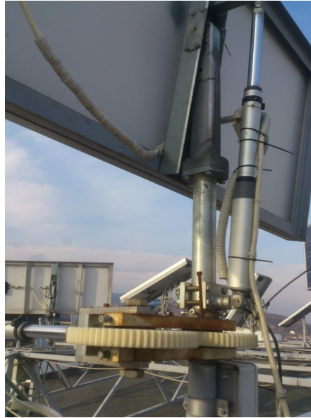
Fig. II.4.1. Angrenaj realizat din poliamidă
