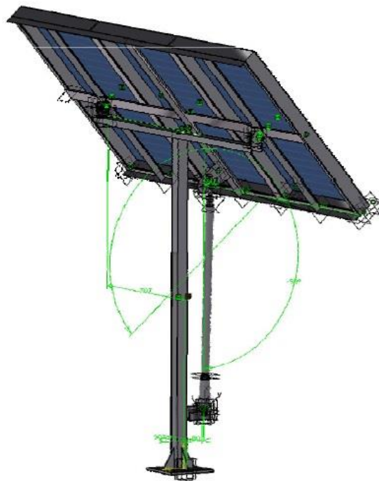
Fig. I.1.8. Soluția constructivă a sistemului de orientare
