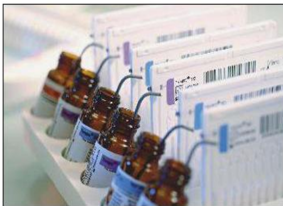
Figura 2.27 Cartelă cu tub de transfer și fiolă cu mediu de cultură specific
