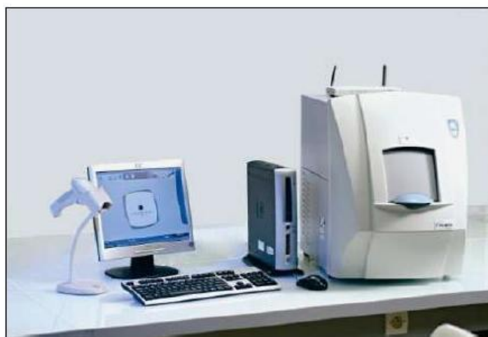
Figura 2.26 Stație de citire: citirea, interpretarea, validarea și transferul rezultatelor
