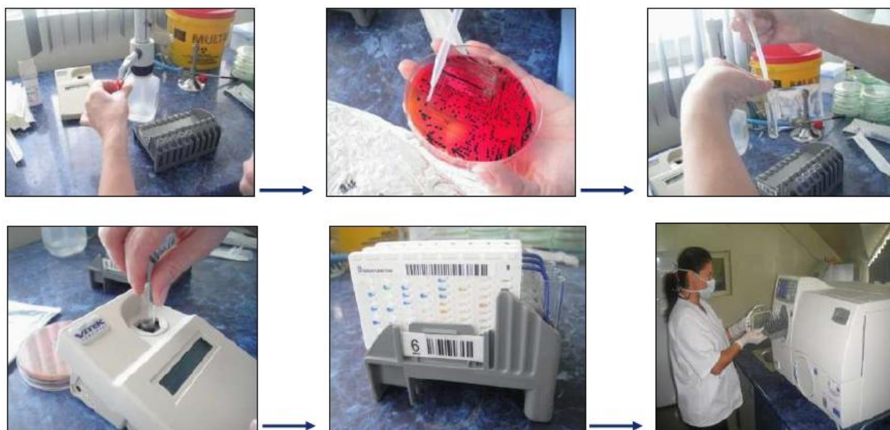
Figura 2.29. Etapele principale pentru identificarea germenilor bacterieni utilizând sistemul Vitek 2 Compact
