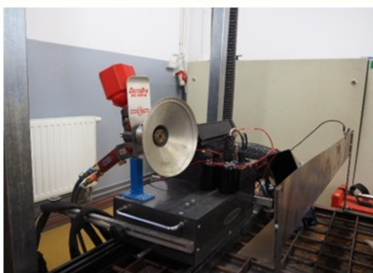
Instalație de pulverizare cu flacără și pulbere Castolin Eutectic DS8000
