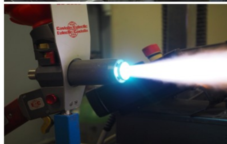
Instalaţie de pulverizare cu flacără şi pulbere Castolin Eutectic DS8000
