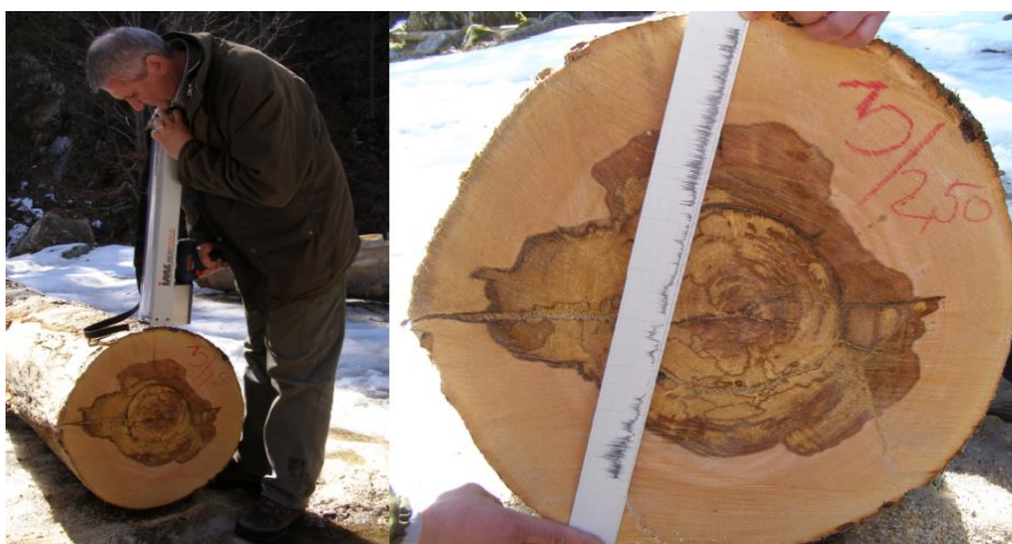
Fig. 2. Utilizarea Rezistografului IML RESIF500 – S la identificarea și măsurarea caracteristicilor defectelor care însoțesc gelivura
