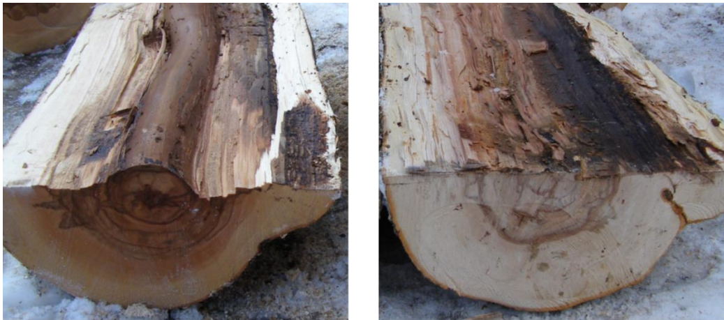
Fig. 4. Aspectul inimii stelate de gelivură în secțiune transversală și longitudinală
