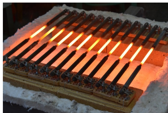
Fig. 3.1.2. Elementele de încălzire: a.) protejarea termică a barelor de Silită; b.) barele de Silită conectate la curentul electric
