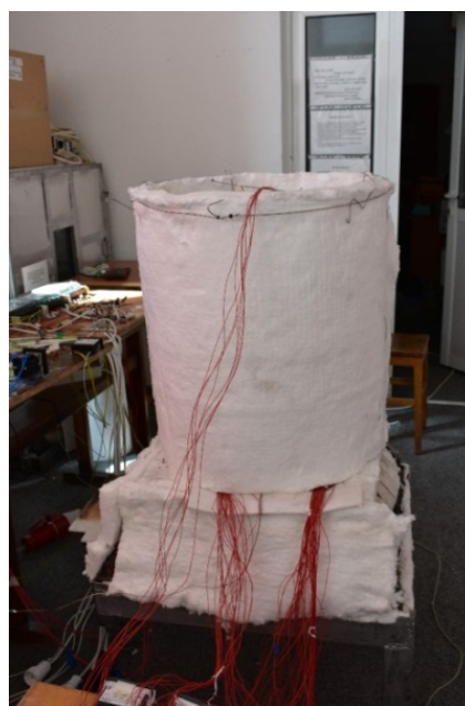
Fig. 4.2.2. Standul de putere mare, împreună cu incinta termoprotectoare a stâlpului
