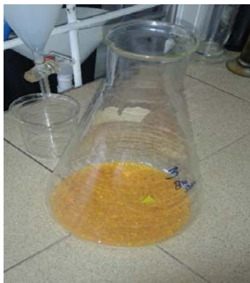
Figura.2.6. Silicagel-ul pentru uscarea biodieselului
