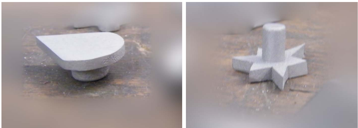
Fig. 3.8. Oval - O 50 UM – stânga – și Stea - S 50 UM – dreapta – fabricate prin procedeul SLM cu un strat de 50 [μm]
