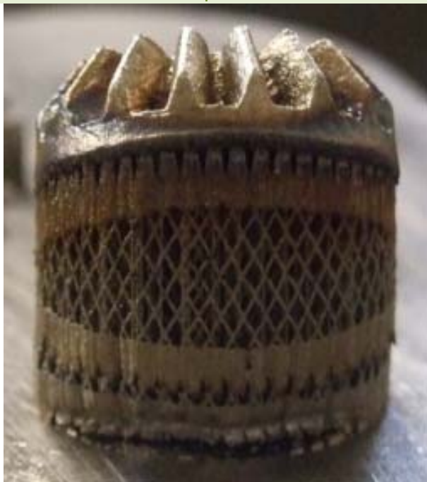
Fig. 5.9. Fabricarea roții dințate pe mașina SLM 250 HL – vedere spate piesă finalizată [BUI14]
