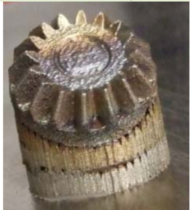
Fig. 5.10. Fabricarea roții dințate pe mașina SLM 250 HL – vedere față piesă finalizată [BUI14]
