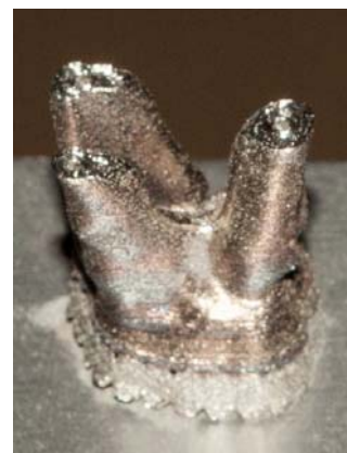
Fig. 5.26. Vedere din lateral primul premolar atașat de masa de lucru.
