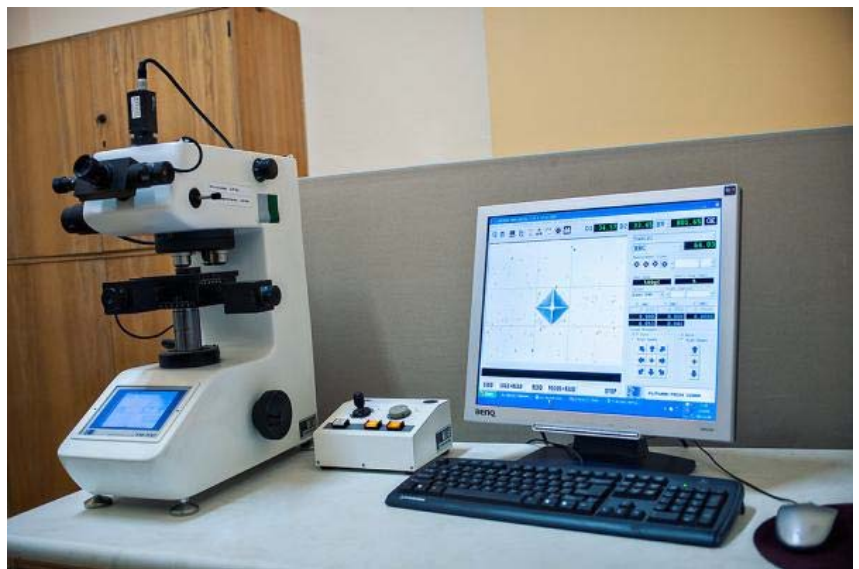
Fig. 3.3. Aparat de testare a microdurității FM 700
