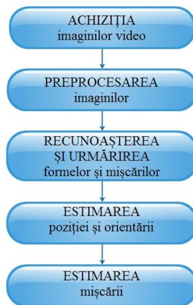
Fig. 0.1 Etapele principale ale procesului de urmărire a privirii și capului cu sisteme vision
