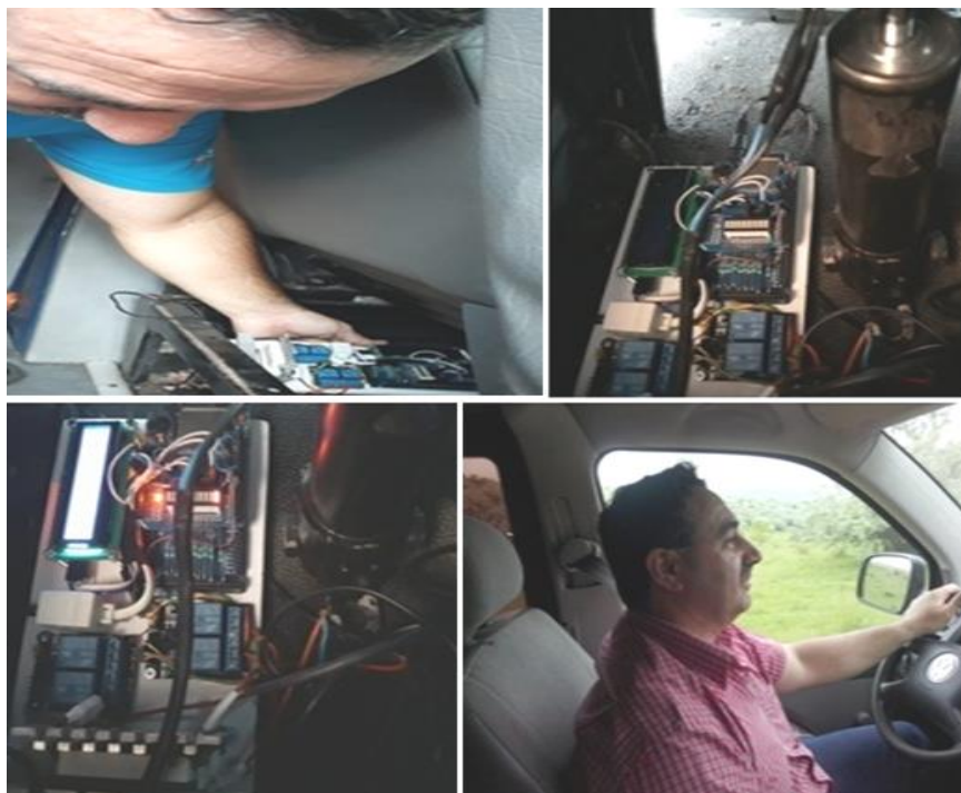
Figura 6.82. Poziționarea sistemului de control și comandă al suspensiei scaunului
