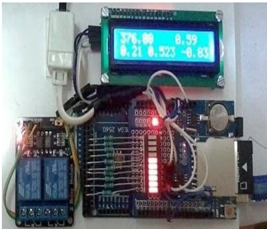
Figura 3.37. Sistemul de comandă al amortizorului magnetoreologic
