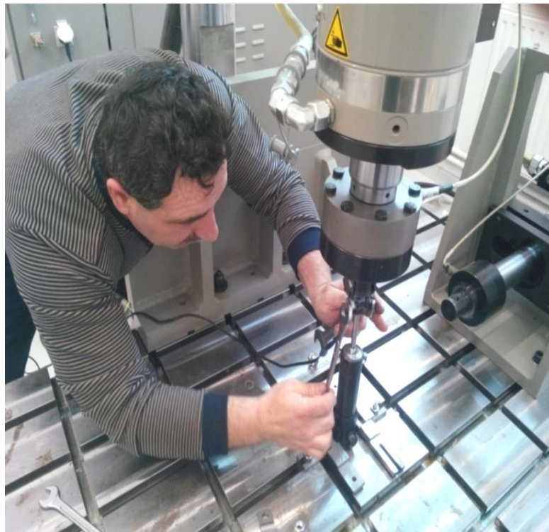
Figura 6.25. Fixarea amortizorului de capul hidraulic al sistemului
