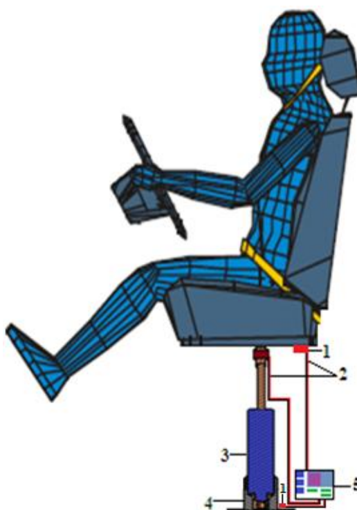
Figura 6.92. Suspensia magnetoreologică a scaunului
