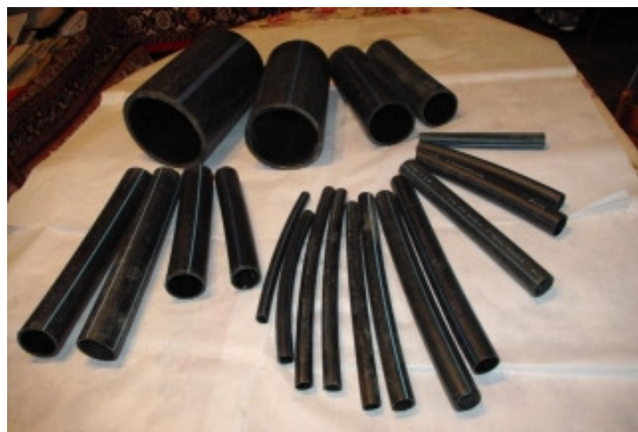
Figura 3.5 Tuburi de diferite dimensiuni folosite în rețelele de alimentare cu apă pentru artere și distribuție la consumatori
