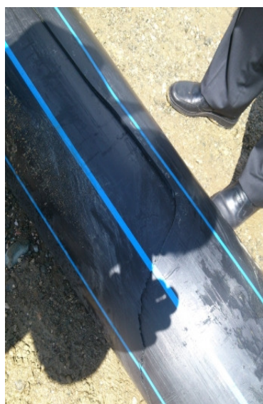
Figura 5.32 Țeavă cu o rupere casantă Figura 5.33 Detaliul ruperii casante a unei țevi de apă
