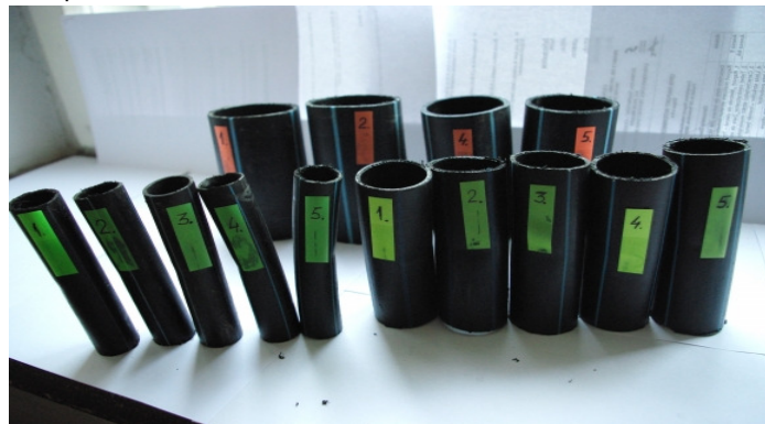
Figura 4.24 Tuburile folosite la încercarea de încovoiere
