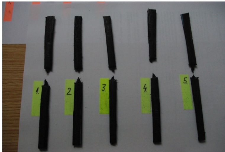
Figura 4.11 Epruvetele rupte la tracțiune 90×6
