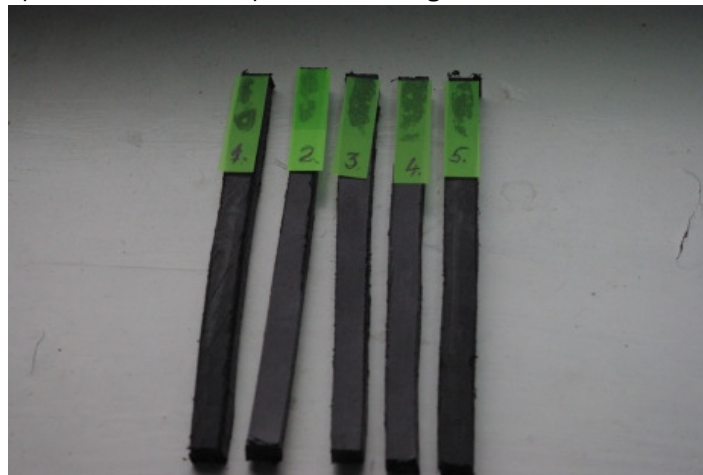
Figura 4.67 Epruvetele supuse încercării ciclice tracțiune-compresiune- 200x11,5
