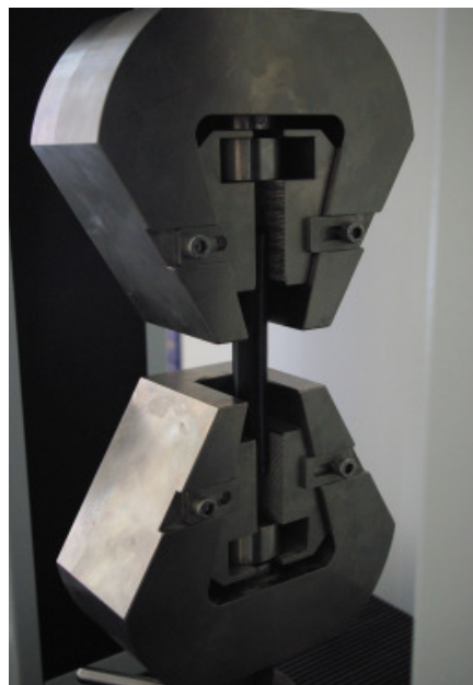
Figura 4.3 Mașina de încercat Lloyd LS 100 Figura 4.4 Detaliul încercării la tracțiune pentru tubul 20x2
