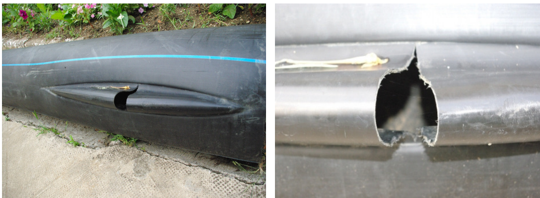
Figura 3.11 Ruptura "cioc de papagal"
