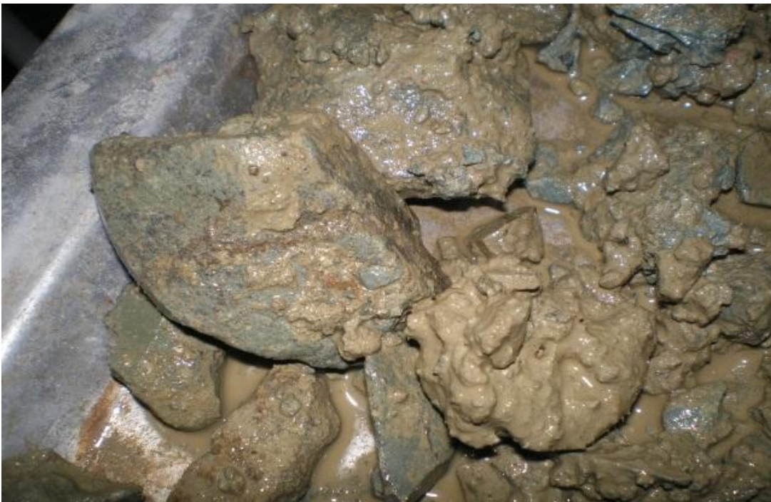
Figura 32 Aspect al materialului rutier din carote
