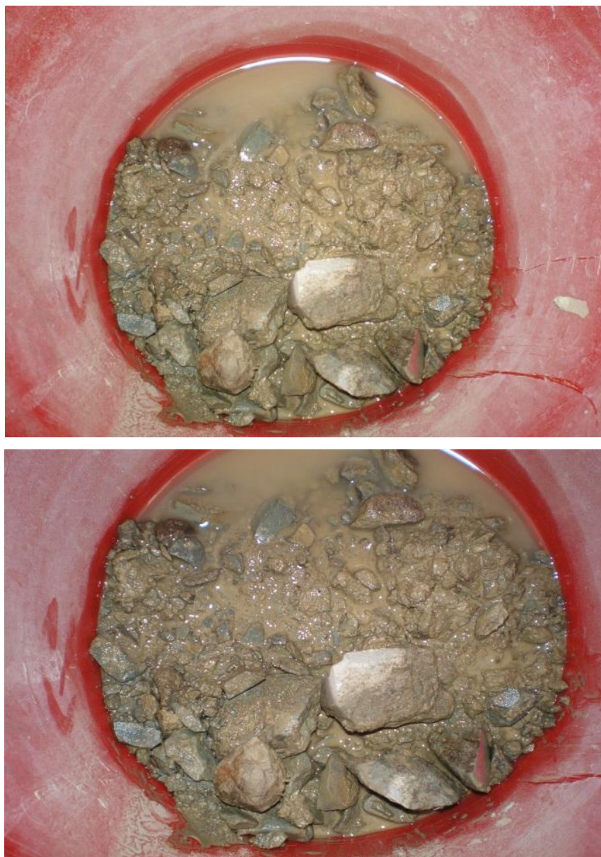
Figura 31 Agregate îmbibate cu apă
