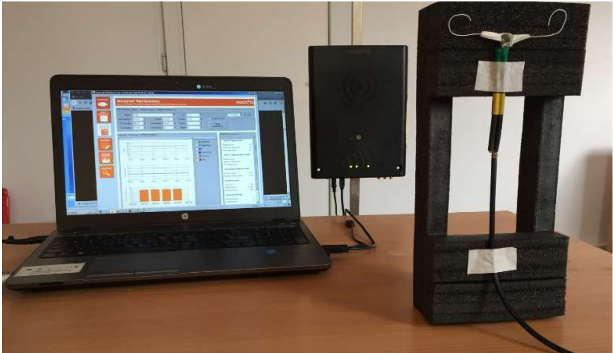
Fig. 5.16. Citire în câmp îndepărtat cu interogatorul RFID
