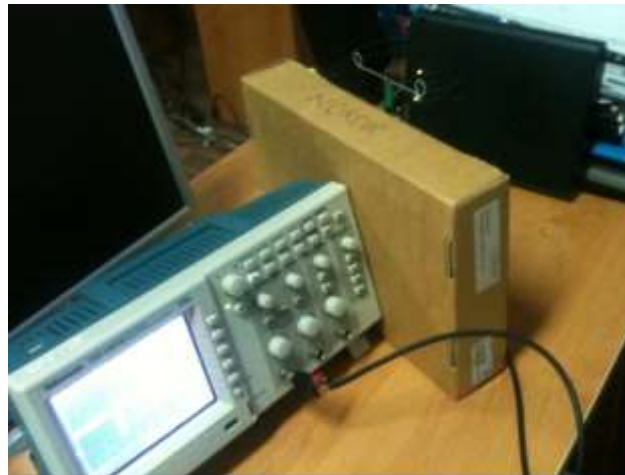
Fig. 5.5. Antenă UHF RFID și Balun-ul de adaptare la osciloscop
