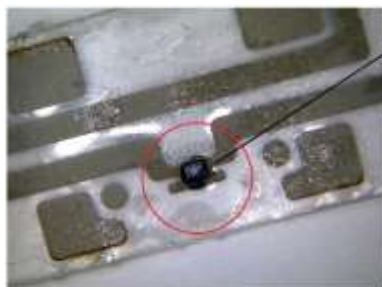
Fig. 4.2. Detaliu privind starea contactelor circuitului integrat al etichetei UHF RFID pasive cu structură de adaptare în impedanță
