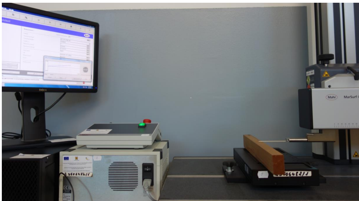
Fig. 5.3. Echipament MarSurf XT20 pentru determinarea rugozităţii suprafeţii prelucrate.
