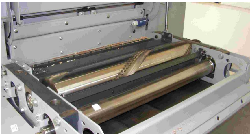
Fig. 5.1. Mașină de rindeluit la grosime D963 cu arbore de lucru cilindric și cuțite dispuse elicoidal, tip „silent power”.
