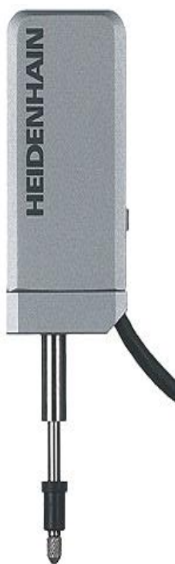
Figura 3.16 Traductorul de deplasare inductiv, pe principiu optic folosit pentru măsurarea adâncimii de gravare
