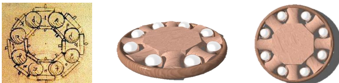
Figura 2.2. Schema pentru un rulment cu bile realizată de Leonardo da Vinci 3 și un model 3D modern 4
