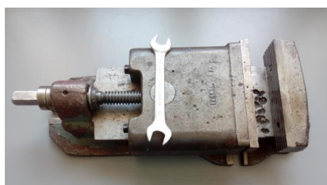
Figura 6.47. Menghina folosită pentru formarea prin lipire a epruvetelor compuse și imagine din timpul procesului de solidarizare
