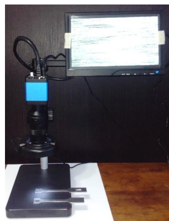
Figura 6.46. Microscopul digital Hayer; ansamblul general și fotografie din timpul cercetării
