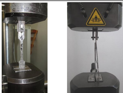
Figura 6.59. Testare epruvete compuse de tip halteră solidarizate cu adezivi (a – înainte de testare; b – după testare)
