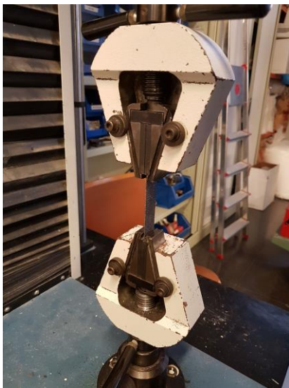
Fig. 6.30. Modul de fixare a epruvetei pe mașina de testare universală electromecanică tip ELIB 50.
