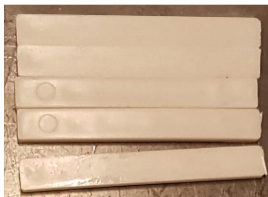
Fig. 6.98 Set de cinci epruvete 15 mass% HA/PLA pentru solicitarea la încovoiere.
