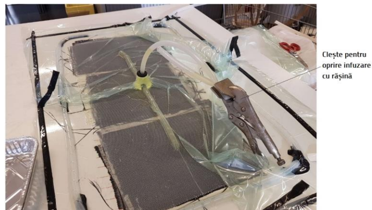
Fig. 6.21. Oprește infuzare cu rășină a compozitului hibrid „uscat” vidat.
