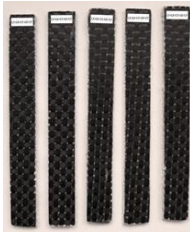
Fig. 6.60 Set de cinci epruvete tip CF/GF/CF/GF/CF pentru solicitarea la încovoiere.
