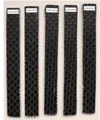
Fig. 6.61 Set de cinci epruvete tip CF/GF/CF/GF/CF pentru solicitarea la încovoiere.
