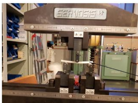
Fig. 6.114 Epruvetă din biocompozit 15 mass% HA/PLA deformată în timpul solicitării la încovoiere.
