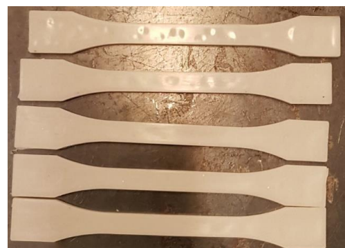
Fig. 6.96 Set de cinci epruvete 15 mass% HA/PLA utilizate la solicitarea la tracțiune.
