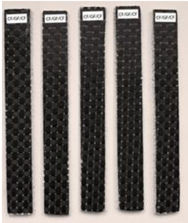
Fig. 6.59 Set de cinci epruvete tip CF/GF/CF pentru solicitarea la încovoiere.
