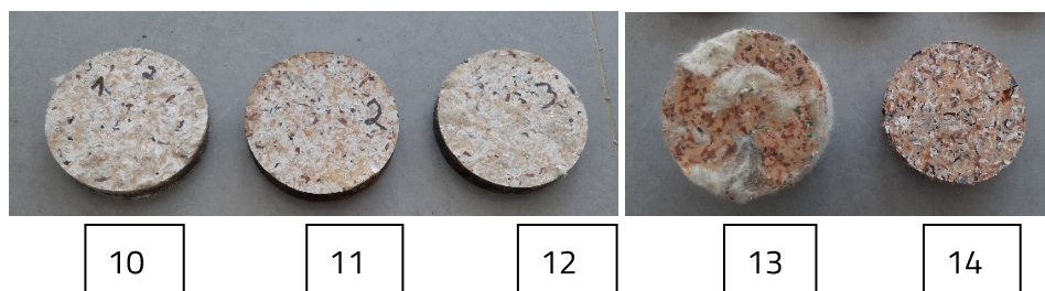
Fig. 4.10. Epruvete din plăci compozite pentru determinarea coeficientului de absorbție acustică 1. FL-C-ABS, 2. C-ABS, 3. FL-PE-ABS, 4. FL-ABS, 5. Hm-ABS, 6. Hm-ABS-FL, 7. L-ABS, 8. FL, 9. Hm, 10. 11. 12. L-ABS, 13. FL-ABS-S
