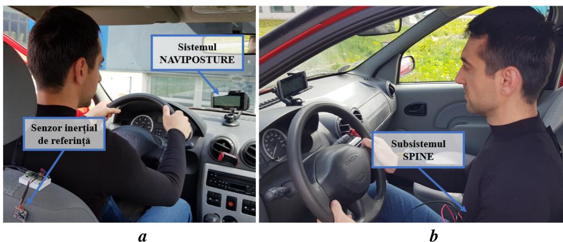
Fig. 5.11 Instalarea sistemului NAVIPOSTURE la postul de conducere: a - vedere din spate, b – vedere laterală
