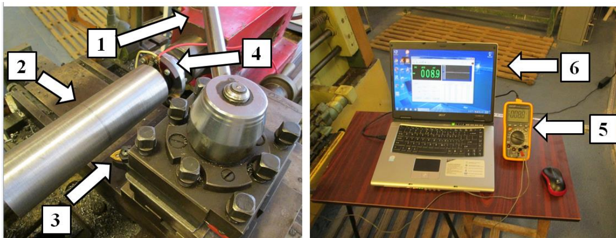
Fig. 5.2. Stand de măsurare cu multimetru ce are conexiune USB și software pentru achiziție date
