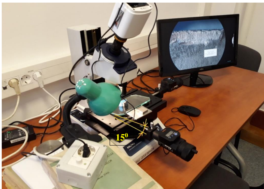
Fig. 3.5. Microscop optico-digital 2D pentru măsurarea uzurii sculei aşchiitoare [DAI19]
