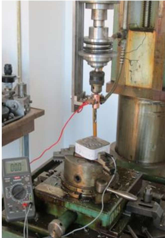
Fig. 4.11. Stand experimental pentru măsurarea curentului electric la burghierea cu intrare lină în aşchiere [DAI17b]
