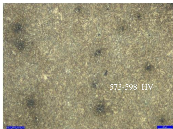
Figura 4.16 Imagine de metalografie optică a oțelului 40Cr130, procesat în următoarele condiții: călit în vid la 1040°C, revenit în vid 510 °C și nitrurat ionic la 520°C. Descriere strat nitrurat 117,6μm. Reactiv de atac: apă regală.500:1
