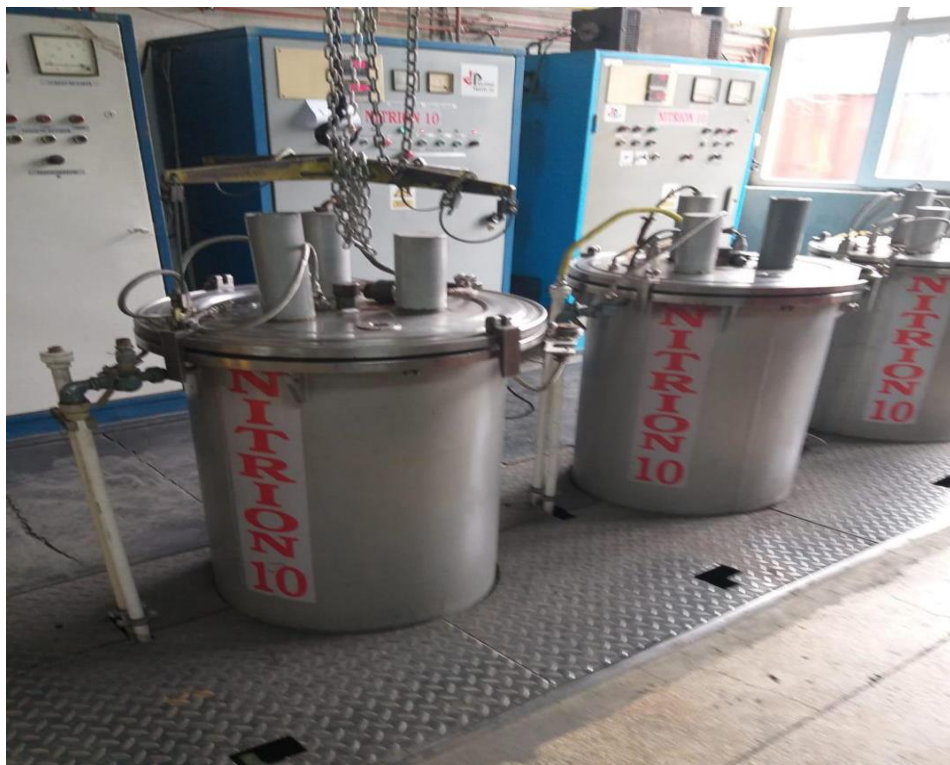
Figura 3.3. Instalație NITRION 10 – Nitrurarea ionică a oțelurilor studiate (SC PLASMA TERM SRL Tg Mureş)
