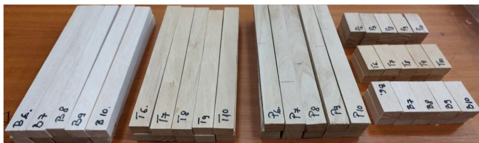
Fig. 12. Epruvetele pentru testări mecanice
