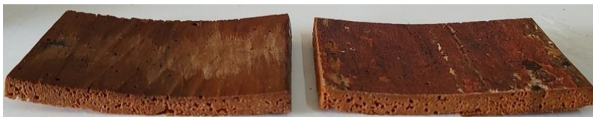
Fig. 25. Curbări puternice după extragerea din apă a epruvetelor secţionate
