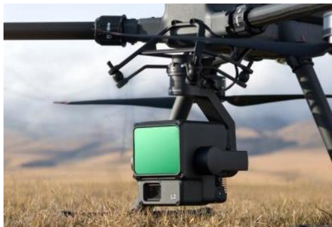
Fig. 16 LiDAR Zenmuse L2 sensor 10
