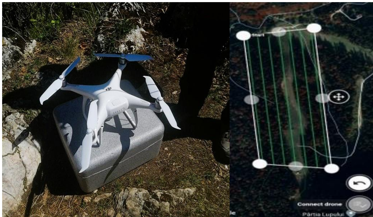
Fig. 3.2 - Dispozitivul UAV folosit de tip dronă, model Phantom 4 Pro v2 (fotografia din stânga) și stabilirea traseului de survolare deasupra arborilor țintă (fotografia din dreapta) (Ciocîrlan 2022)
