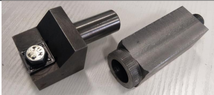
Fig. 7.6. Cele două corpuri ale cuțitului cu tăiș tangențial înclinat
