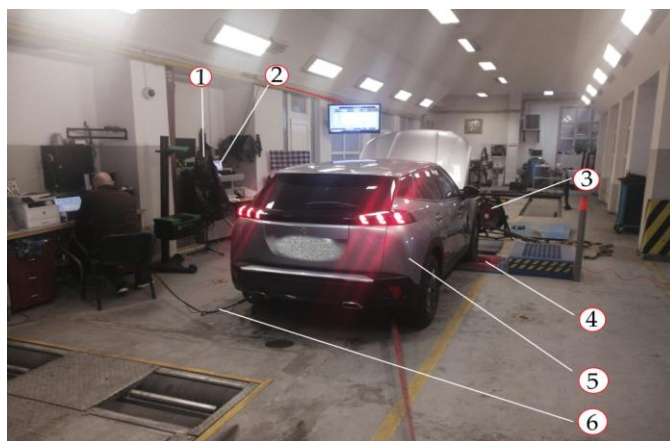
Fig. 4.2 - Laborator pentru cercetarea experimentală: a) Schema standului de cercetare; b) Vedere a standului de cercetare; 1. Sistem de conectare al instalației electronice al sistemul vehiculului (OBD II), 2. Sistem de control, 3. Ventilatoare (2 bucăți), 4. Role cu sisteme de frânare cu curenți turbionari, 5. Vehicul testat, 6. Sistem de eșantionare a gazelor de evacuare pentru analizor.
