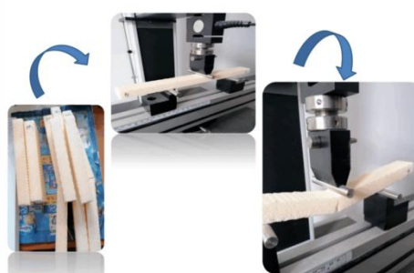
Inercarea la încovoiere în 3 pct a compozitului din polistiren extrudat - PE
